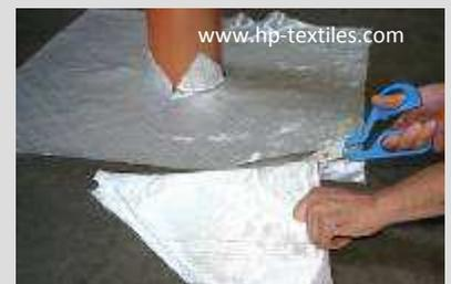
Abb. 16: Versetztes Einschneiden der zweiten Lage (im Hintergrund die erste Lage)
